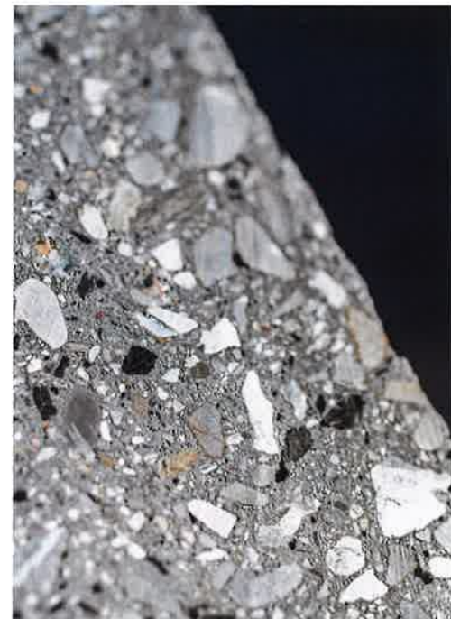
Der verarbeitete CO 2 -Beton.
